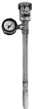
Figura 4. Tensiómetro que permite determinar cuándo regar.
